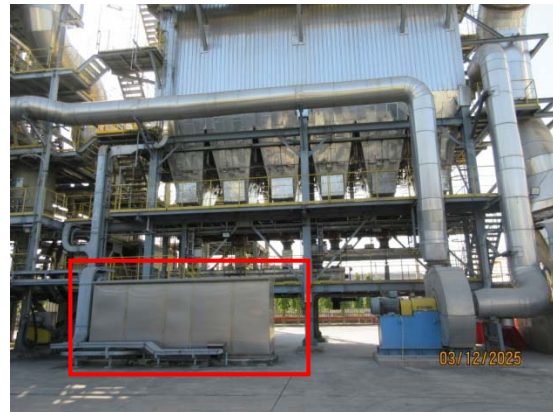
รูปที่ 16 ระบบดูดซับด้วยผงถ่านกัมมันต์ (Odor Adsorption Unit)
