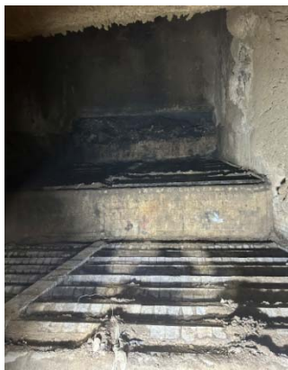
รูปที่ 5 เตาเผาแบบตะแกรง (Stoker Grate Firing)
